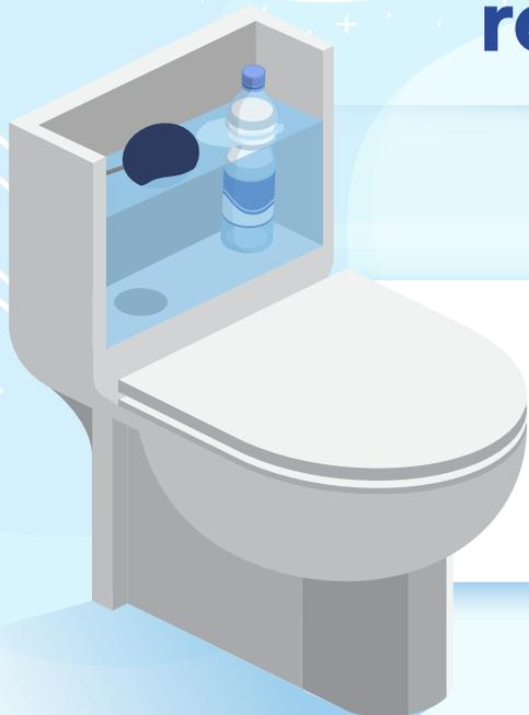
Coloca una botella con arena en el tanque del inodoro para reducir cada descarga a un máximo de 6 litros.
