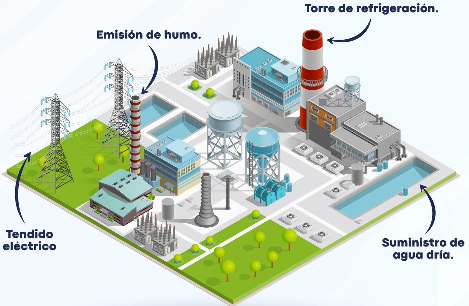
Una central termoeléctrica es una instalación que produce energía mecánica a partir del vapor formado al hervir agua en la caldera para mover el rotor del generador y obtener la energía eléctrica.
